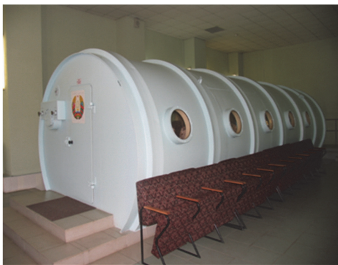
Рис. 1. Многоместная барокамера «УРАЛ-АНТАРЕС» на 15 посадочных мест городского центра гипобарической терапии и бароклиматической адаптации (г. Витебск, Беларусь).
